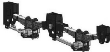
Suspensión tándem REFORZADA con ballesta multihoja
